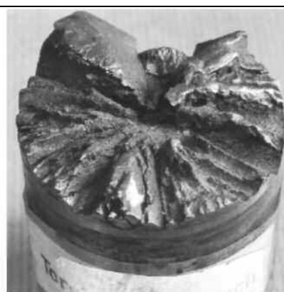
Рисунок 10.3.3 Интенсивное разрушение при кручении вала диаметром 60 мм из-за максимального момента вращения, вызванного использованием неподходящей муфты с наличием люфта
