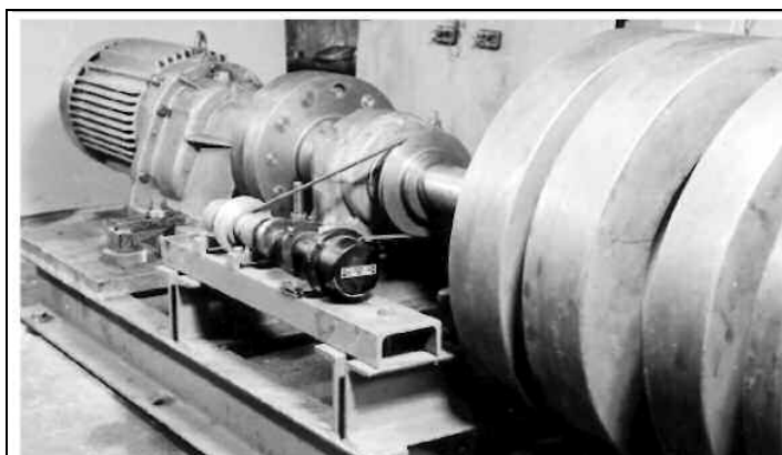
Рисунок 10.3.2 Реверсивные операции, определяющие термическую и механическую пригодность мотор-редуктора роликового стола
