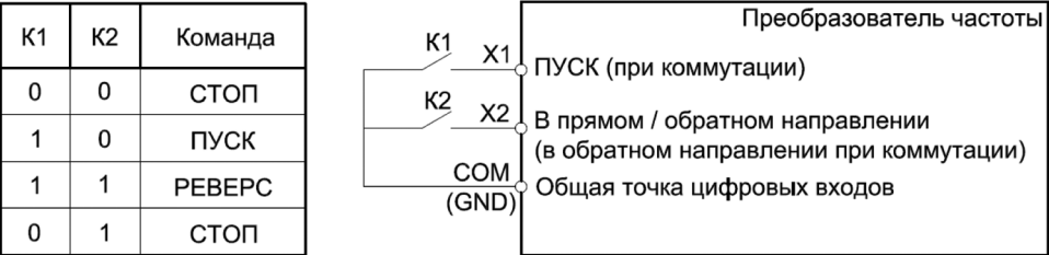
Рисунок 10.9-6 – Двухпроводная схема управления 2
