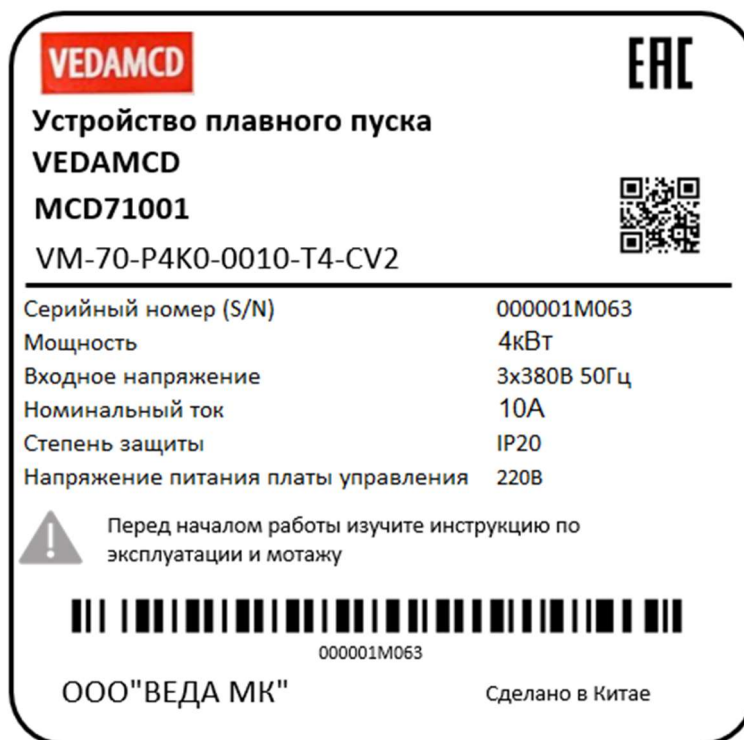
Рисунок 1. Пример маркировки устройства плавного пуска
