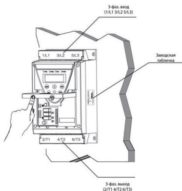
**Примечание:** В качестве соединительного провода для клемм рекомендуется использовать провод сечением 1 мм<sup>2</sup> и более.
