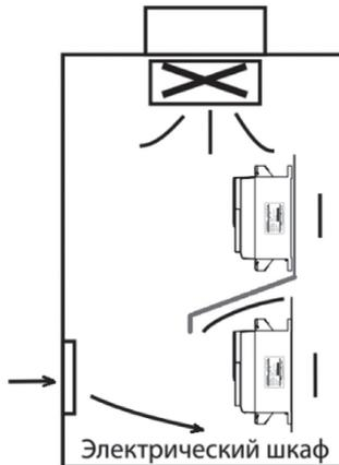
Рис. 3-1с. Установка нескольких устройств друг над другом
