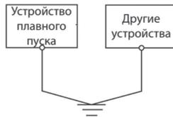
Рис. 3-8б. Схема заземления
