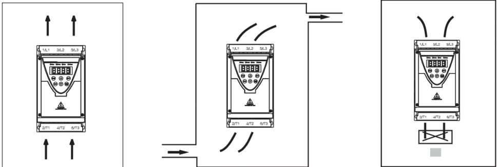
Рис. 3-1d. Направление вентиляции
