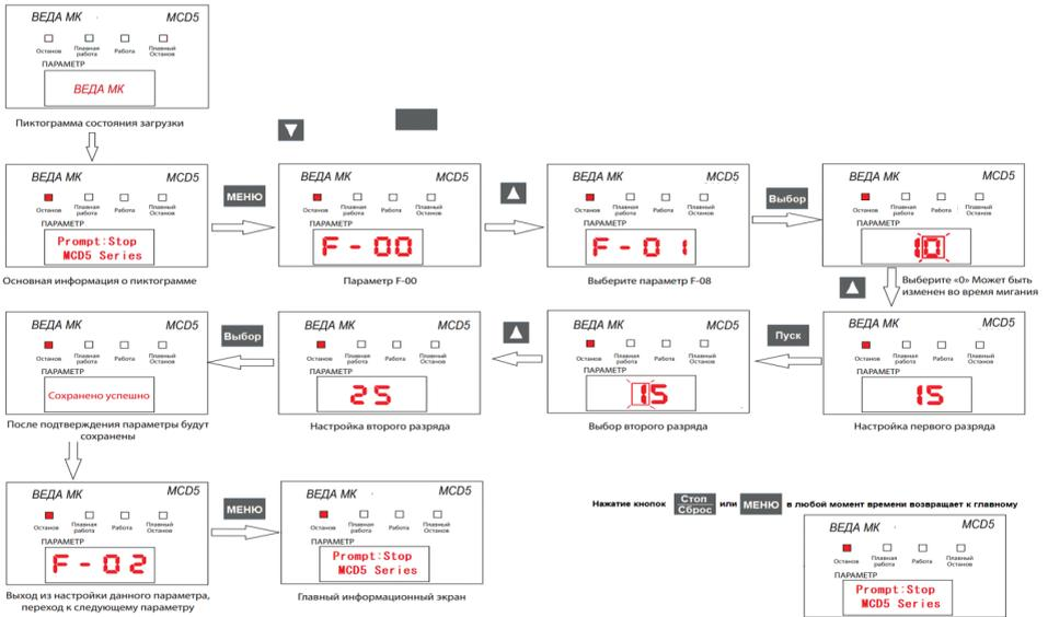
Рис. 4-4. Схема экрана
