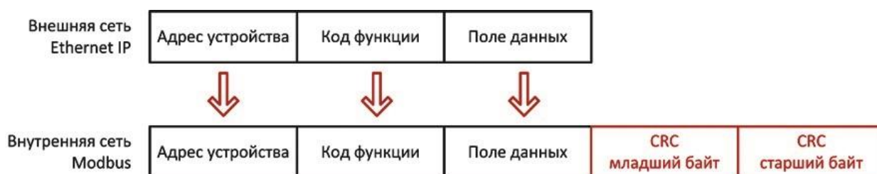
Рис. 6.15 - Структура преобразования сообщения
