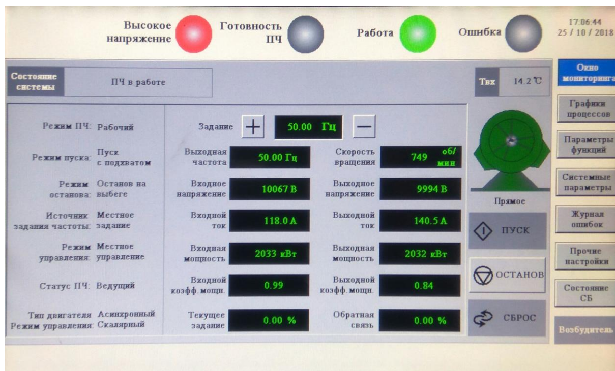
Рис. 5.1 - Окно мониторинга при местном режиме управления
