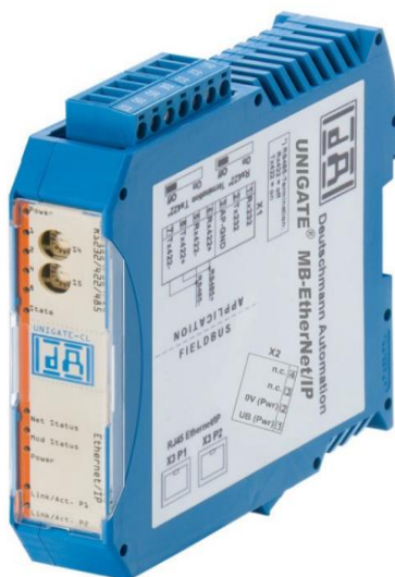
Рис. 6.14 - Модуль связи Ethernet/IP
